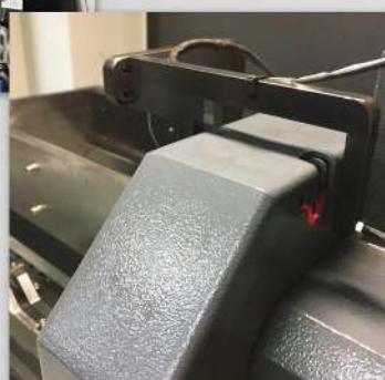
砂輪磨耗裝置 可設定根據研磨支數 進行補償值
