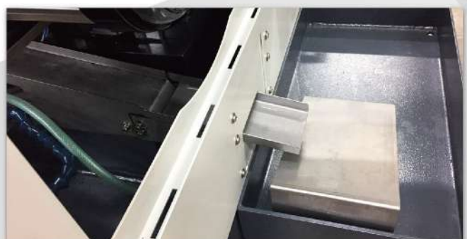
▲ 人工件緩衝集合槽 ▼ 推料至設定長度夾持切斷
