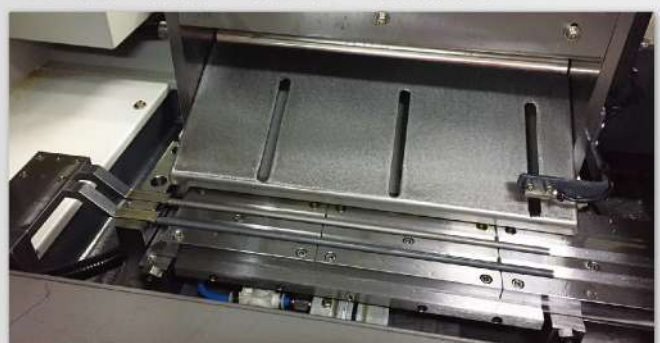
▲ 人工件緩衝集合槽 ▼ 推料至設定長度夾持切斷
